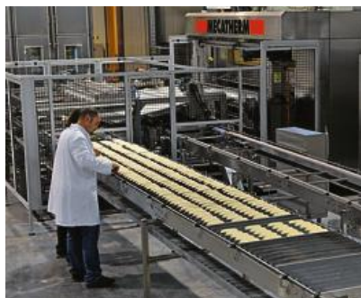
Mecatherm peut produire 47 tonnes de pain de mie par jour et 12.000 baguettes à l'heure. Photo J.-P. Reiland
